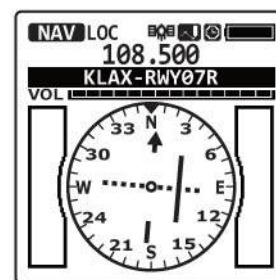
С GPS модулем, но без GP сигнала регистрируется направление взлетно-посадочной полосы.
